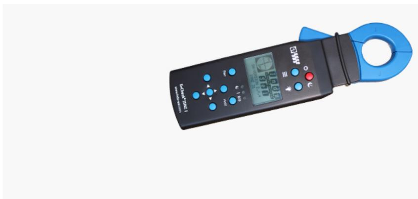
В сложных промышленных системах часто возникают нежелательные взаимодействия между источником питания и технологией управления, что может привести к сбоям в технологии управления. Интеллектуальный **токовый** зажим EMCheck<sup>®</sup> ISMZ I представляет собой мобильное устройство обнаружения токов наведенных помех на промышленных предприятиях, которое независимо записывает, оценивает и записывает данные.
